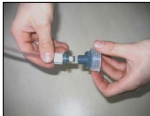
Abb. 14: Kanisteranschluss Solekupplung abziehen
