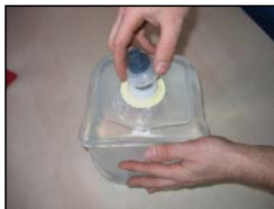
Abb. 15: Kanisteranschluss Solekupplung festschrauben
